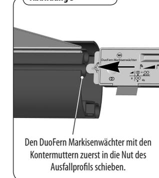
Den DuoFern Markisenwächter mit den Kontermuttern zuerst in die Nut des Ausfallprofils schieben.
