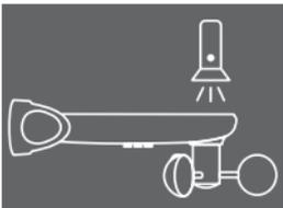
Den Lichtsensor z.B. mit einer hellen Taschenlampe beleuchten.
