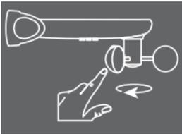
Das Windrad mit der Hand schnell drehen.
