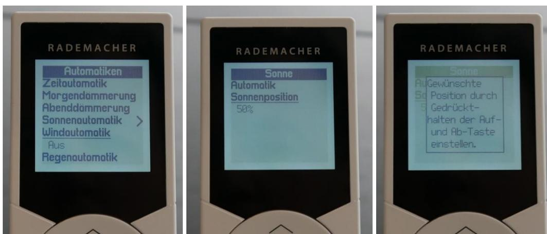
Tipp: Um die Einstellungen für jedes Gerät vornehmen zu können, müssen Sie das Menü nicht verlassen, sondern wählen einfach mit der Gruppen-/Kanalauswahl-Taste das nächste Gerät aus.
