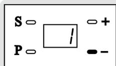
1. Drücken Sie nach der Referenzfahrt auf „-“ (evtl. mehrfach drücken) bis „1“ angezeigt wird.
