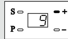
2. Drücken Sie auf „+“ (evtl. mehrfach drücken) bis „9“ angezeigt wird.
