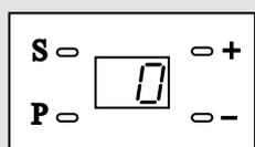
3. „0“ wird zyklisch angezeigt, um die Programmierung abzuschließen und den Antrieb in den Ruhezustand zu versetzen.
