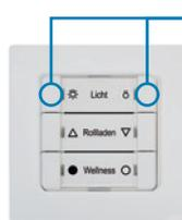
Anmeldemodus aktivieren. Betätigen Sie die beiden oben liegenden Tasten bis die LEDs der Tasten 1 & 2 grün blinken.
