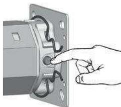
Taste am Motorkopf kurz drücken, bis der Motor kurz anrückt.
