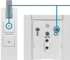
Betätigen Sie die Verbinden- und Auf-Taste gleichzeitig 4 Sek., bis die LED grün blinkt.
