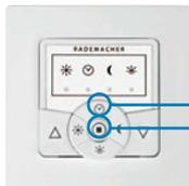
Betätigen Sie die Uhr- und die Stopp-Taste gleichzeitig 4 Sek. bis die LED grün blinkt.
