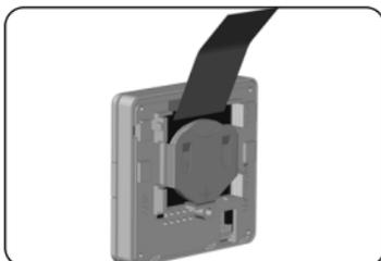
5. Drücken Sie zum Schluss das Bedienteil und den Abdeckrahmen auf den Wandhalter, bis der Rahmen bündig an der Wand anliegt.
