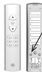
„Verbinden-Taste“ (s. Pfeil) kurz drücken. Anschließend Kanaltaste 1-6 wählen.
