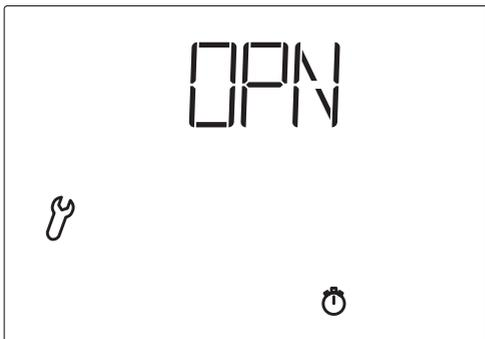
Fahren Sie die Markise oder Jalousie zunächst vollständig ein, so dass nicht beschattet wird. Drücken Sie dann die Taste **SET** um zum nächsten Schritt zu gelangen.
