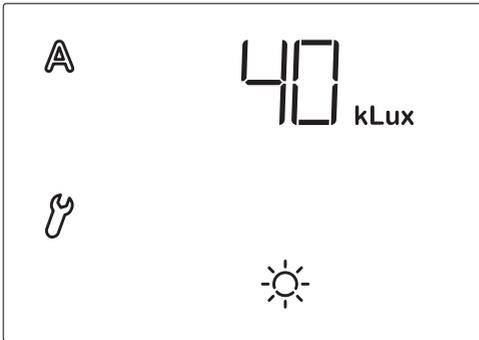
Die Anzeige der Sonnenintensität erfolgt in Kilolux (kLux). Der Wert 1 kLux wird schon bei bedecktem Himmel erreicht, bei 20 kLux kommt die Sonne gerade heraus und 100 kLux werden bei wolkenlosem Himmel zur Mittagszeit erreicht.
