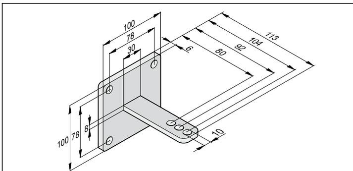
2. Befestigungshöhe vom Boden bis Unterkante Beschlag min. 50 mm. Dies kann durch die Befestigungsmöglichkeiten des Antriebes am Torflügel eingeschränkt sein.
