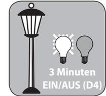
Gleichzeitig wird ein angeschlossener elektrischer Verbraucher eingeschaltet und nach ca. drei Minuten automatisch ausgeschaltet (Werkeinstellung).
