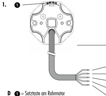
**D** ① = Setztaste am Rohrmotor
