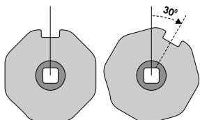
Bei Rohrmotoren mit Hinderniserkennung hat der ab Werk montierte Freilaufmitnehmer radiales Spiel.
