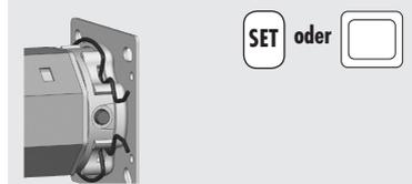
**Die Setztaste (11) am Rohrmotor und die SET-Taste (oder den externen Taster, falls angeschlossen) wieder loslassen.**
